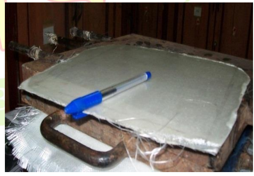
Fig.No:5. Setting the composite after fabrication Fig.No:6. GFRP composite
