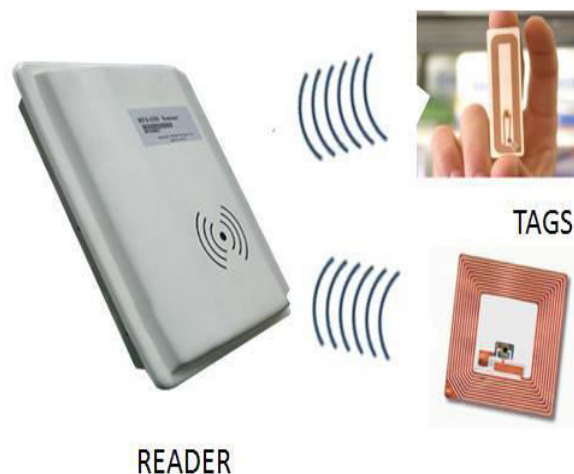
Fig: 4.1.2. Passive RFID tag and RFID reader
